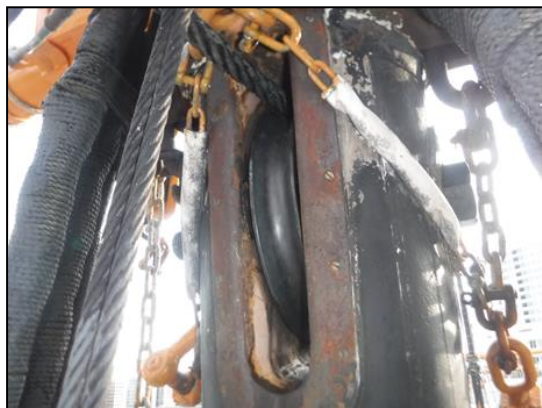
ミズンマスト・アッパーゲルン ハリヤードタイ、シーブ交換
