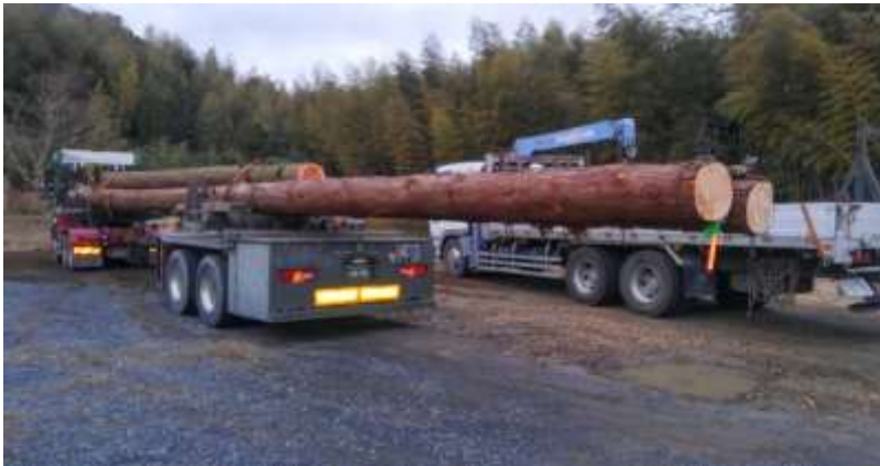
工事名： 帆船日本丸LGヤード改修工事 工程名： ポールトレーラー 陸輸 撮影日時： 2019年12月27日
