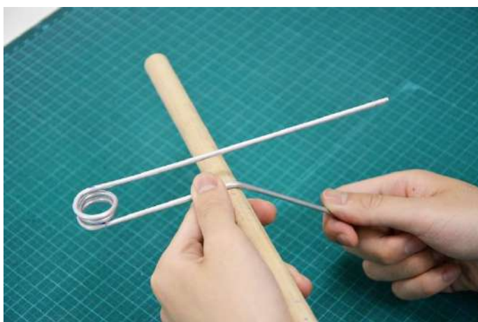
アルミパイプを「く」の字の形に曲げます
