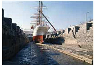
第一号ドックの帆船日本丸 1991(平成3)年2月 平成2年度の日本丸船体整備工事はドックを排水して行った。日本丸は渠底中央に設置された盤木という台の上に乗っている。扉船(戸船)から渠頭部を見る。当館蔵
