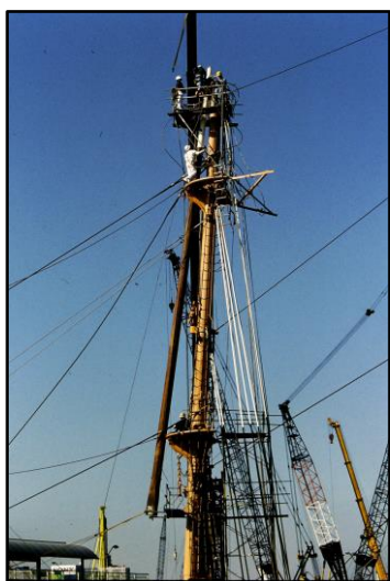
メインマストのトップゲルンマスト(長さ約18メートル、重さ約700キログラムの檜材)は上部トップボードの孔を通して引き揚げました
