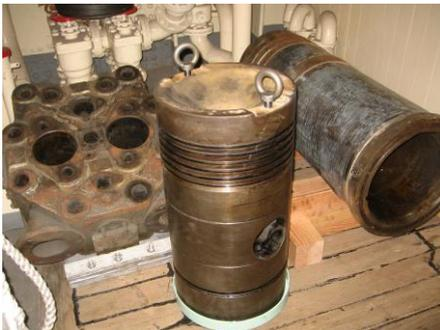
予備品として船内に保管されていた、ピストン・シリンダライナー・ヘッドカバーで使用された形跡が見られる
